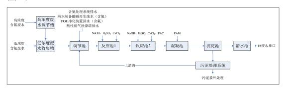
(3) 研磨废水处理系统: 拟采用"混凝沉淀法"进行处理, 其处理流程如下图所示:
